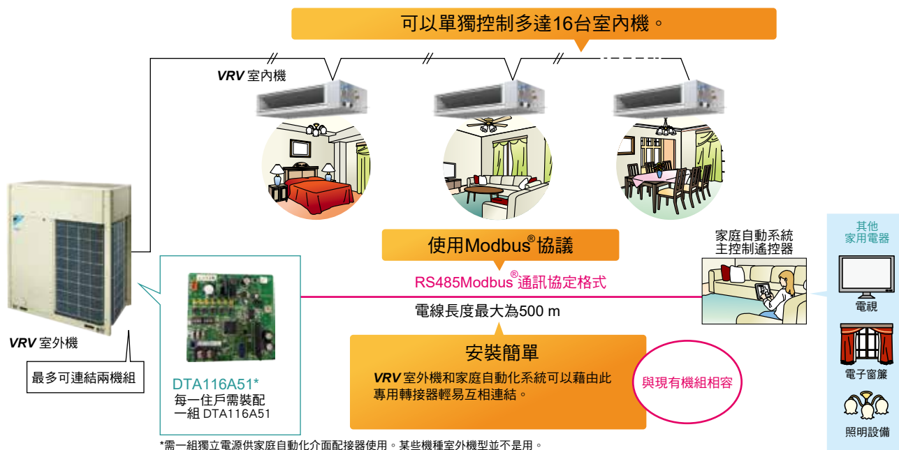
使用家庭自動化轉接器DTA116A51示意圖
